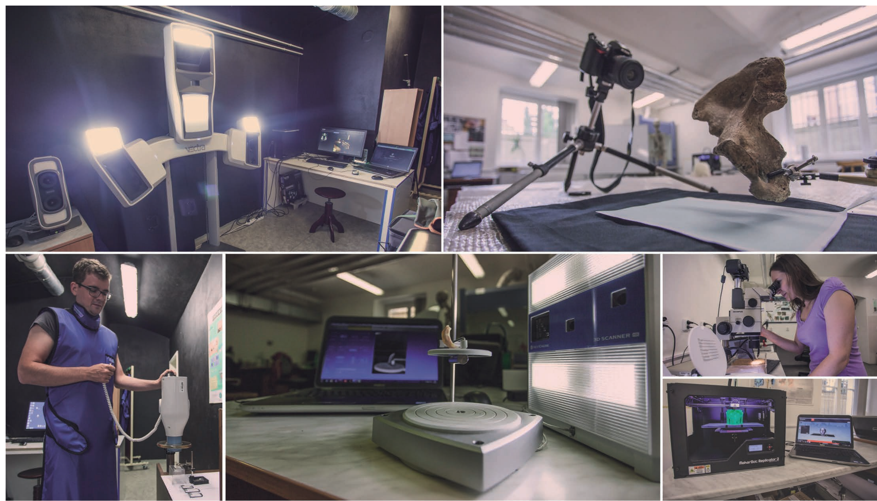
Přístrojové vybavení Laboratoře morfologie a forenzní antropologie. Zleva nahoře: optické skenery Vectra M1 a XT, fotogrammetrie. Zleva dole: ruční RTG přístroj Aribex, NextEngine 3D Scanner, práce s mikroskopem (nahore), 3D tiskárna MakerBot Replicator 2 (dole).
